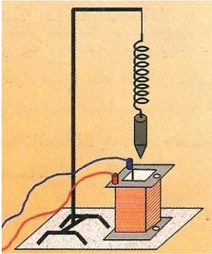
11 عند توصيل الوشيعية بالعمود الكهربائي تتمغنط وتجذب المسمار .
