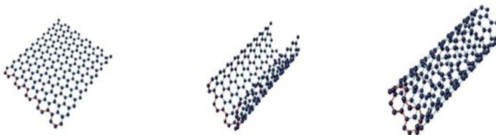
شكل (3) : التفاف صفيحة الجرافين لتشكيل الأنبوب النانوي
