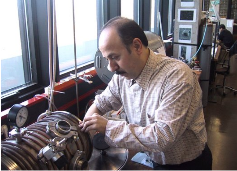
شكل (14): صورة الدكتور واصف السخانية في مختبر النانوتيوب مع مفاعل إنتاج الأنابيب النانوية ( Nanotubes Reactor) .
