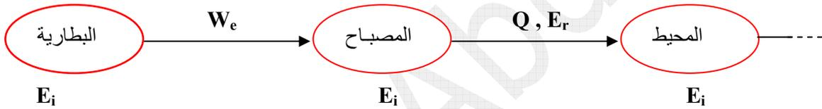
إن للبطارية طاقة داخلية بسبب التفاعلات الكيميائية الحادثة فيها ، ينتج عن ذلك تيار كهربائي يمر في المصباح (تحويل كهربائي) ، فيشتعل المصباح مكتسبا طاقة داخلية نتيجة حركة الإلكترونات في سلكه المتوهج ، فيسخن هذا السلك وينشر إشعاعات ضوئية وكمية من الحرارة إلى الوسط الخارجي ، أي المحيط (تحويل حراري و تحويل بالإشعاع) .
