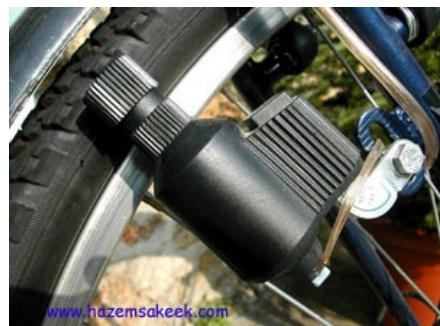
دينامو مثبت على إطار دراجة هوائية لتزويد المصباح بالتيار الكهربائي
