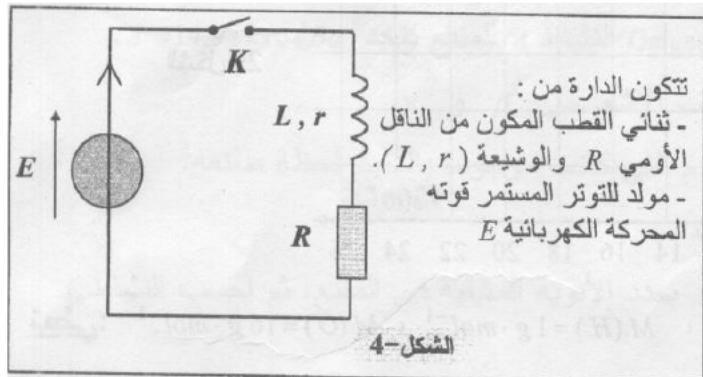
لدراسة تطور شدة التيار الكهربائي  $i(t)$  المار في ثانية القطب  $RL$  بدلالة الزمن ، وتأثير المقادير  $R$  و  $L$  على هذا التطور ، نركب الدارة الكهربائية (الشكل-4).
