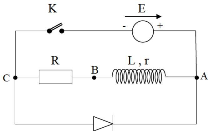
بواسطة مولد توثر ثابت قوته المحركة الكهربائية  $E$  ، ناقل أومي مقاومته  $\Omega = 90$  ، وشيعة ذاتيتها  $L$  و مقاومتها الداخلية  $r$  (غير مهملة) ، قاطعة  $K$  نحقق الدارة المبينة في الشكل المقابل ثم نغلق القاطعة عند اللحظة  $t = 0$  .
