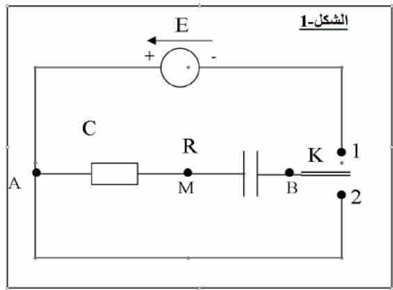
لدراسة تطور التوتر الكهربائي بين طرفي مكثفة نحقق الدارة الكهربائية المبينة في الشكل التالي و المكونة على التسلسل من : مولد للتوتر الثابت قوته المحركة الكهربائية  $E = 12 \text{ V}$  ، مكثفة سعتها  $C$  ، ناقل أومي مقاومته  $R$  .
