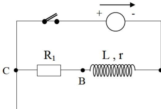
بواسطة مولد توفر ثابت قوته المحركة الكهربائية  $E$  ، ناقل أولمي مقاومته  $R$  ، وشيعة ذاتيتها  $L$  و مقاومتها الداخلية  $\Omega = 20$  ، قاطعة  $K$  نحقق الدارة المبينة في الشكل المقابل .
