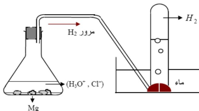
نملأ أنبوب اختبار مدرج بالماء و ننكسه على حوض مملوء بالماء و عند انطلاق الغاز يبدأ مستوى الماء في الأنابيب و بالنزول ، حيث يمكن في كل لحظة قياس حجم الغاز بقراءة تدريجة مستوى الماء في الأنابيب .
