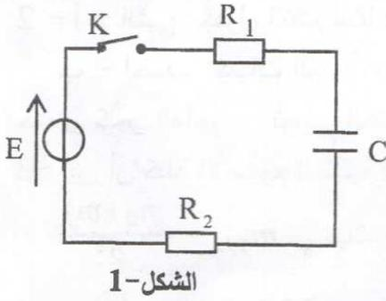
تتميز المكثفات بخاصية تخزين الطاقة الكهربائية و إمكانية استغلالها عند الحاجة . لدراسة هذه الخاصية نربط مكثفة غير مشحونة سعنتها C على التسلسل مع العناصر الكهربائية التالية :
