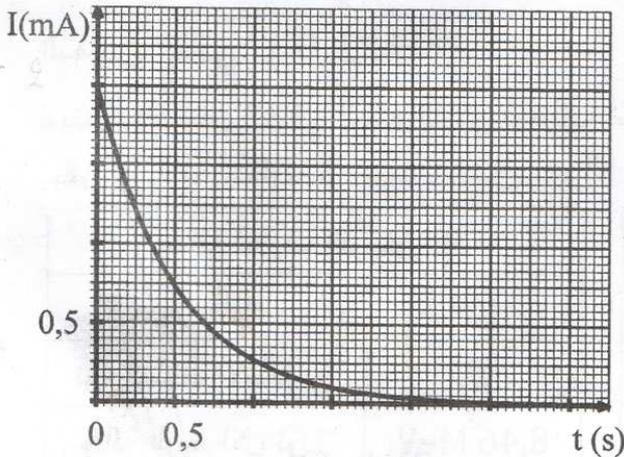
2- بواسطة لاقط شدة التيار الكهربائي موصول بالدارة و بواجهة دخول لجهاز إعلام آلي نحصل على منحنى تطور الشدة  $i(t)$  للتيار الكهربائي (الشكل-2) .
