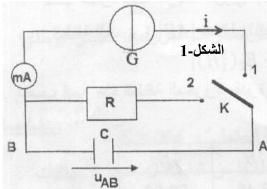
نعتبر الدارة الكهربائية المبينة في (الشكل-1) و التي تتألف من مولد  $(G)$  للتيار الثابت ، مكثفة سعتها  $C$  ، ناقل أومي مقاومته  $R$  . نريد تعيين سعة المكثفة  $C$  ، لذلك نضع في اللحظة  $t = 0$  البادلة  $k$  في الوضع (1) لتشحن المكثفة بالمولد  $G$  الذي يعطي تيارا ثابتا شدته  $I = 2 \text{ mA}$  .
