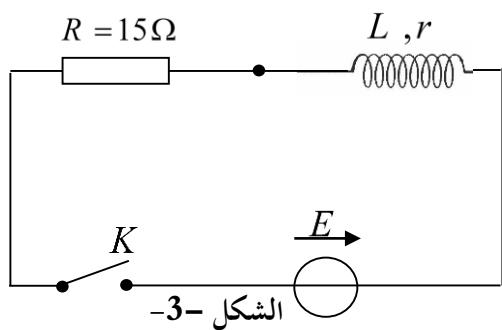
بغرض معرفة سلوك و مميزات وشيعة مقاومتها ( $r$ ) وذاتيتها  $L$  نربطها على التسلسل بمولد ذي توتر كهربائي ثابت  $E = 9V$  وقاطعة  $K$  . الشكل (3)
