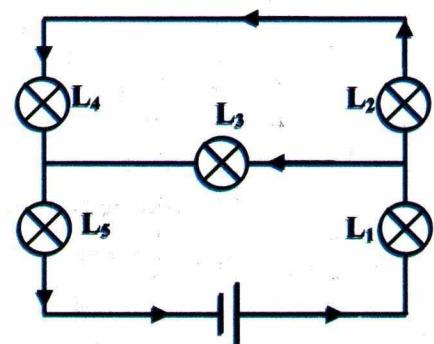
المصابيح التي لها نفس شدّة الإضاءة هي التي تعبرها نفس شدّة التيار الكهربائي بما أنها متماثلة،
