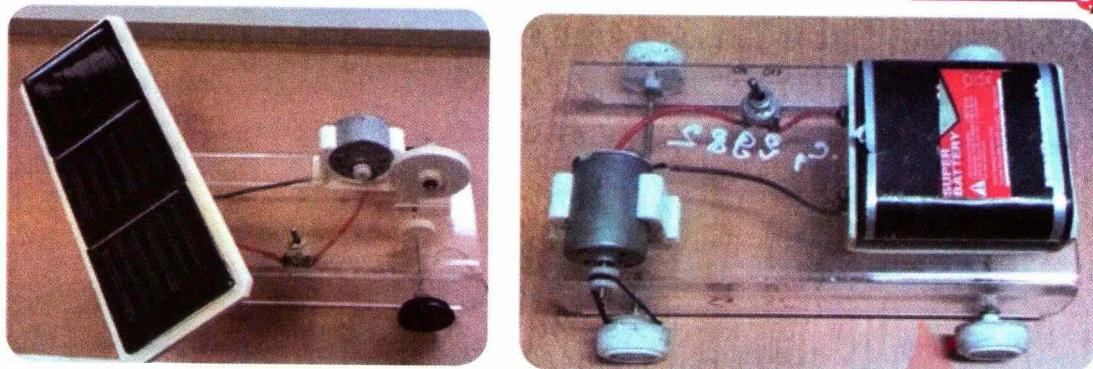
ولنsehen ٢ التركيب التجاري لتحريك عربة بواسطة بطارية (يمين الصورة) وبواسطة الخلايا الكهروضوئية (يسار الصورة)
