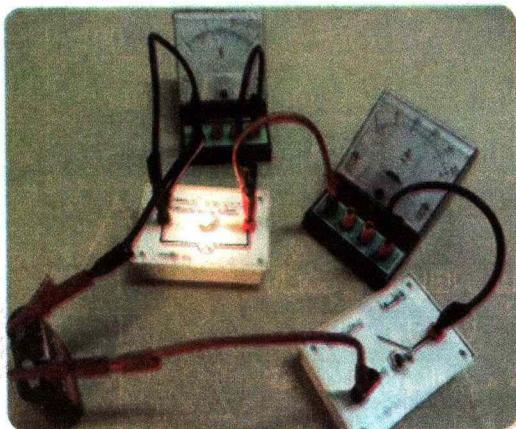
قياس التوتر الكهربائي بين طرفي مصباح التوهج
