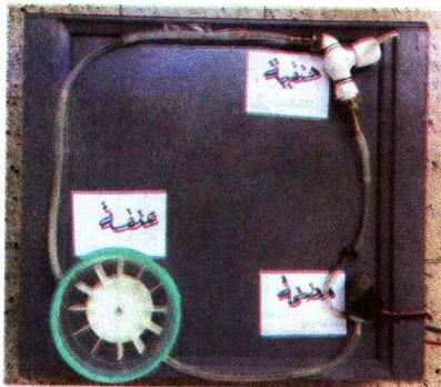
صنع طه وعبد القادر تركيبة للنموذج المائي تحاكي نموذج التيار الكهربائي، وهذا ليشرحوا لزملائهم مميزات التيار الكهربائي المستمر، ساعدتهم في ذلك بالإجابة عما يلي:
