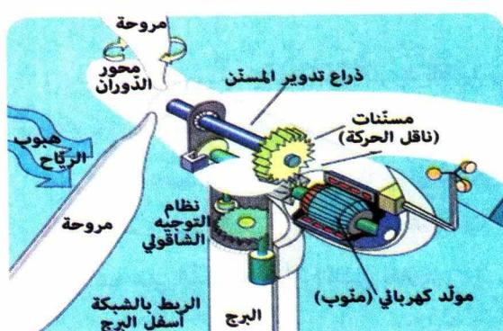
تركيبة توليد الطاقة الكهربائية من طاقة الرياح
