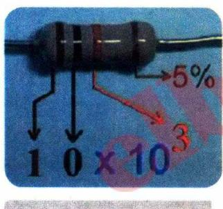
**المقاومة الكهربائية** هي قابلية المواد المعدنية النّاقلة لمقاومة مرور التّيار الكهربائي فيها، يرمز لها بالرمز (R) وتقاس بطريقة غير مباشرة بتطبيق قانون أوم للناقل الأومي أو بطريقة مباشرة بشفرة الألوان أو باستعمال جهاز الأوم متر (أو جهاز متعدد القياسات) الذي يربط على التفرّع بين طرفي النّاقل الأومي، الوحدة الدوليّة لقياس قيمتها هي (الأوم) ويرمز لها بالرمز ( $\Omega$ )، من أجزائها الميلي أوم (m $\Omega$ ) ومن مضاعفاتها الكيلوأوم (k $\Omega$ ).
