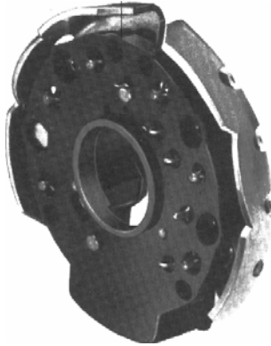
الشكل رقم ٨ - يوضح طريقة توصيل الموحدات مع عضو الاستنتاج
