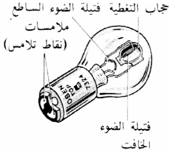
شكل رقم ٢ - يوضح مكونات مصباح الإضاءة
