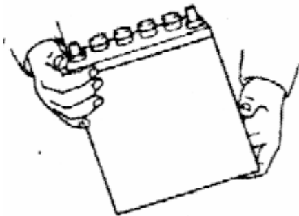
الشكل رقم - ١٧ - يوضح الطريقة الصحيحة والخاطئة لحمل البطارية بعد إخراجها من مكانها بالسيارة
