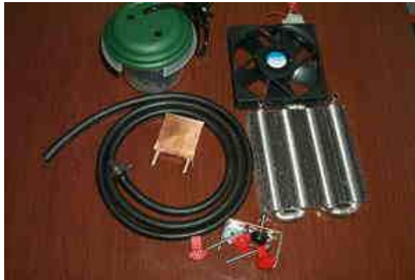
جهاز لتبريد المعالج بالمياه ( يشبه الراديتور )
